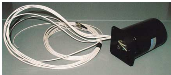
図9 真空中でも動作すべく改良された光電子増倍管HAMAMATSU R6504S
