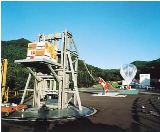
図 16-1 観測装置を大型放球装置にセット
