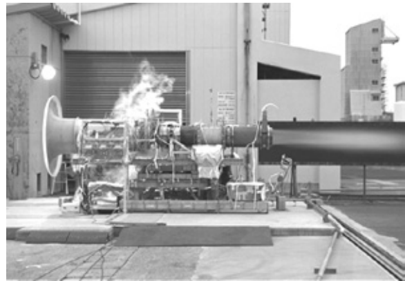
図4 ATREX-500地上燃焼試験 [6]
