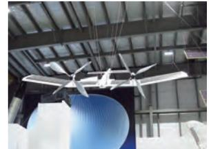
火星飛行機 (地球で実験中)
