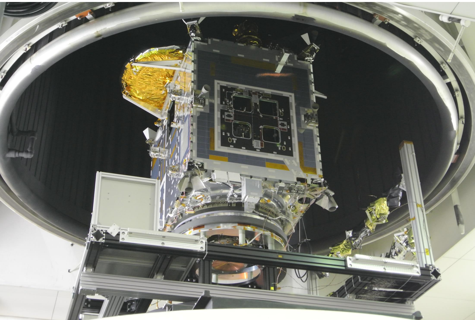
打上げ前の「はやぶさ2」。熱真空試験を終え、チャンバから出てくる様子(2014年撮影)
