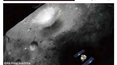
衝突装置により人工的なクレータができた瞬間(イメージ) 「はやぶさ2」は小惑星の背後に回り込み、破片を回避する Moment of creation of an artificial crater by SCI (conceptual drawing). Hayabusa2 hides behind the asteroid to avoid collision with fragments.
