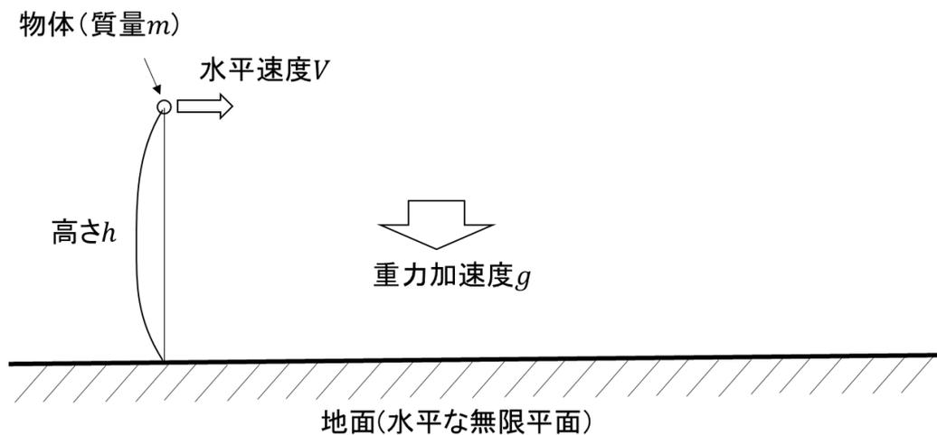
図 1-1 水平方向に射出された質量  $m$  の物体の運動
