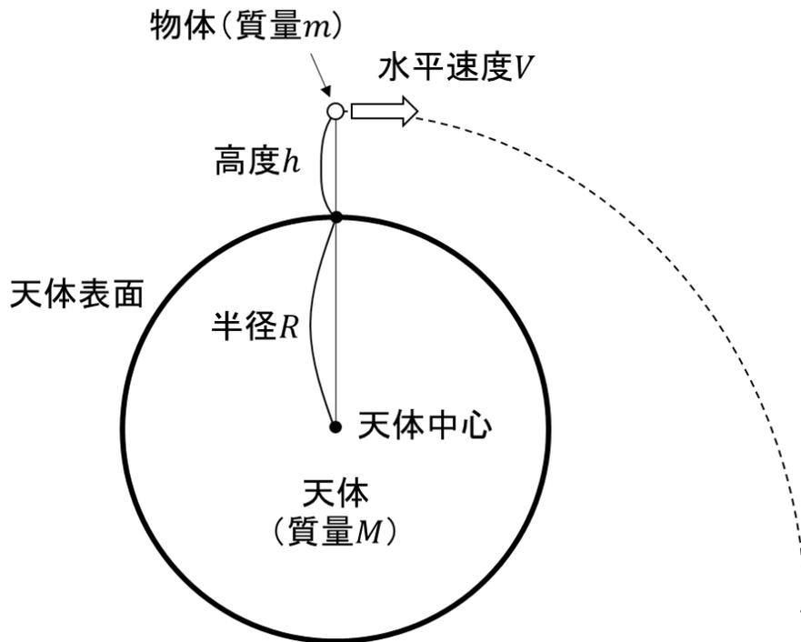
図 1-2 天体まわりの質量  $m$  の物体の運動
