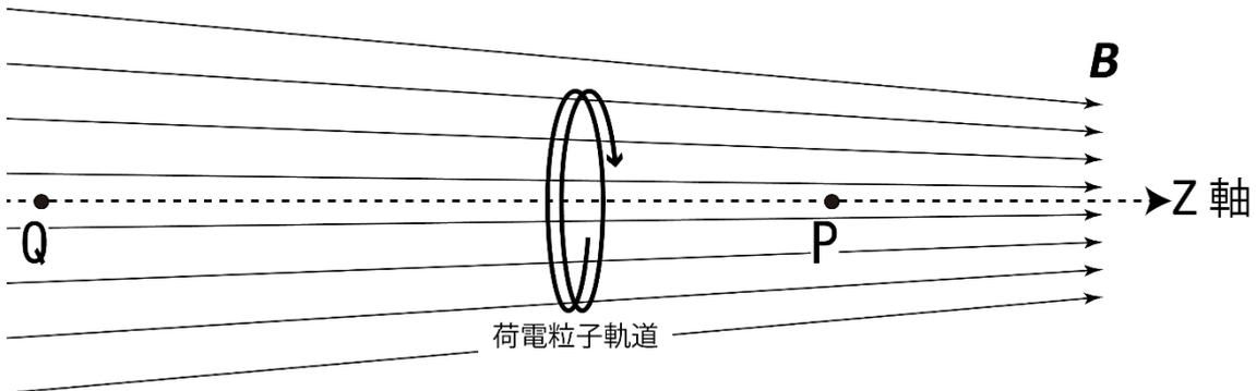
図 2-1 磁場の中でサイクロトロン運動を行う荷電粒子
