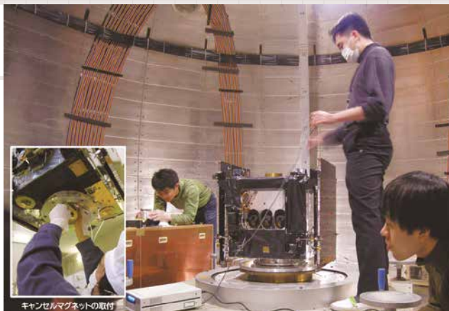
INDEX衛星の磁気モーメント測定 (2005年4月)
