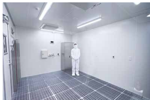
内観：小柄ながら本格派。作業中もISO Class 7 HC (Highly Controlled) を達成。
