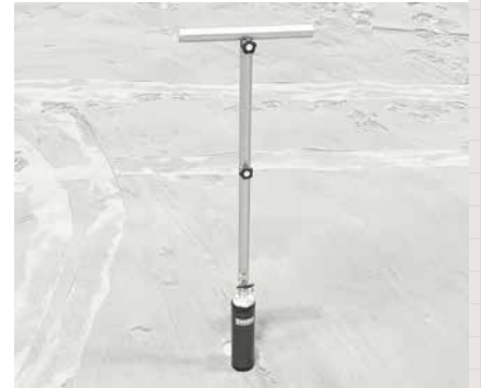
小型震源装置 (PASS) のプロトモデル。上側の取手を宇宙飛行士が地面に押し付けて下部の振動装置を駆動させます。
