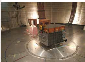
磁気シールド室内で子機B1の磁場ノイズを測定している様子。
