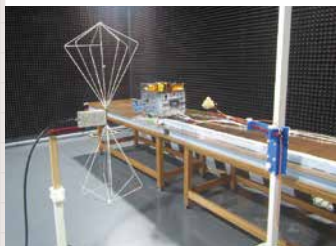
EMC試験において子機B1に対してアンテナから電磁ノイズを当てている様子(場所:EMCジャパン第8テストサイト)。
