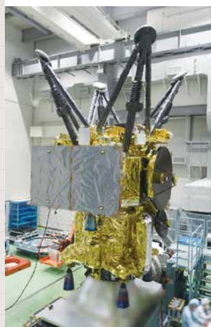
MMX探査機 正弦波振動試験(加振前)の様子
