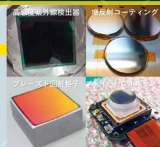
写真：LAPYUTAで要素開発を進めている試作の例
