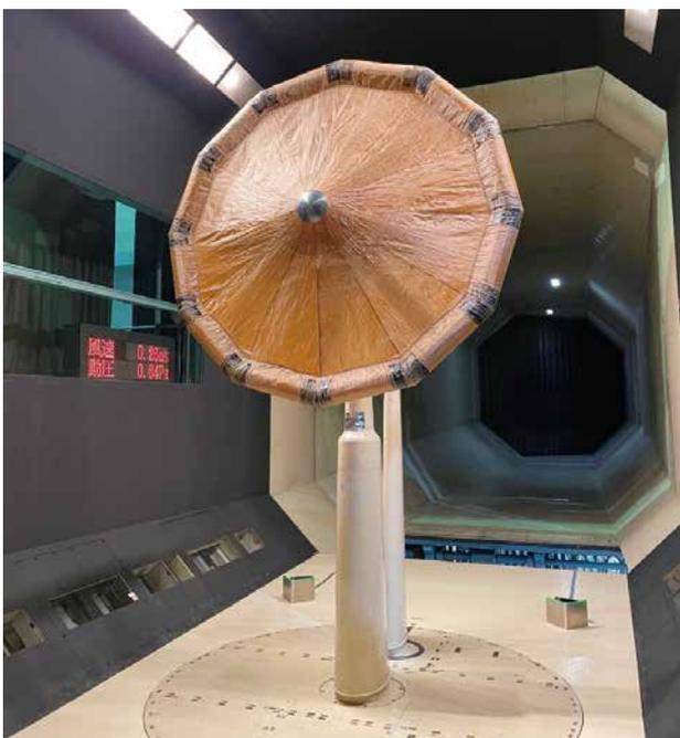
図2：我々が開発してきた直径2.5mの展開型エアロシエルの風洞試験の様子 (JAXA 調布航空宇宙センター 6.5m×5.5m低速風洞にて)
