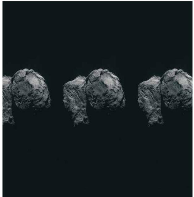
図2: NAC TDI+多重露光撮像のシミュレーション画像の一例。距離850km、相対速度40km/s、彗星核直径10kmを仮定した計算である。多重露光機能によって1枚の画像の中に複数の像が写る。それぞれの像の露光中のブレはTDIによって低減する。
