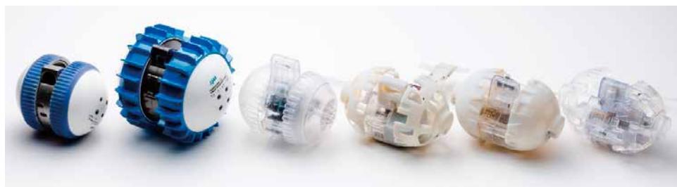
図2：過去の試作機。初期のモデルでは、内部の機器や配線に干渉が無い目視で確認するため、ボディ部分に透明の樹脂を使っている。このあとに製作した環境試験モデルやフライト品には、宇宙環境に耐えられるようにアルミなどが用いられている。
