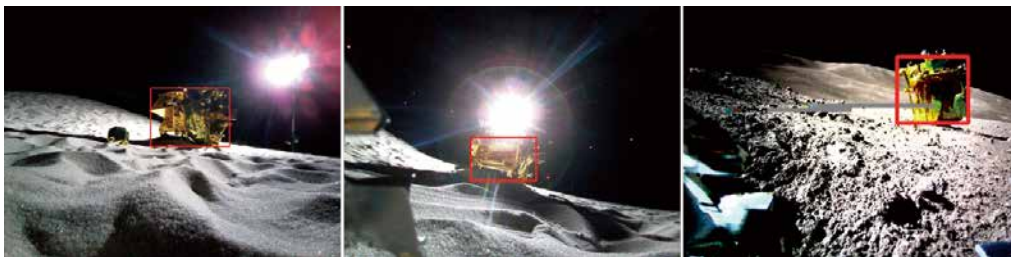
図4：(左・中央) 探査フィールドでSLIMの模型を撮影した試験結果と(右)月面で撮影した写真。赤枠はSLIMの検出結果を示している。探査フィールドを使った地上試験では逆光の場合でもSLIMを検出できることを確認していた。右図は、ロボットが月面でも正しくSLIMを検出できていたことを示している。
