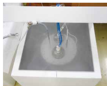
地震計の極低温度試験状況。加圧チェンバー装置に地震計をセットし(左図)、装置全体を液体窒素に入れて試験をします(右図)。
