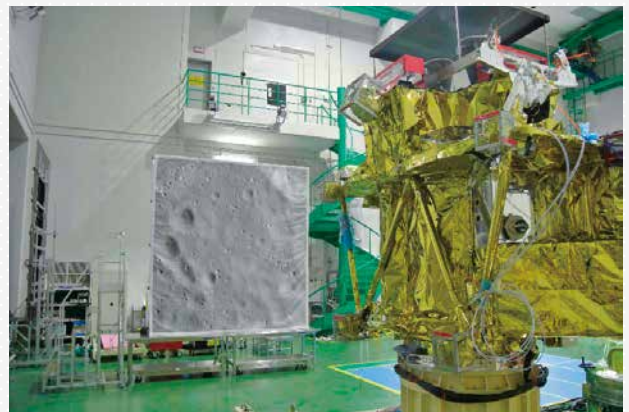
図2：FMシステム試験での画像航法系の総合確認の様子。
