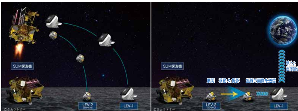
図3：LEV-2の動作シーケンス。LEV-2はもう一台のロボットLEV-1と共にSLIMから月面に放出される。その後、LEV-2は完全自律制御でSLIMの周辺を走行・撮影し、そのデータをLEV-1経由で地上に送信する。地上からの指示・コマンドは一切受けずに、ロボット自身がすべてを判断して自律的に動作する。
