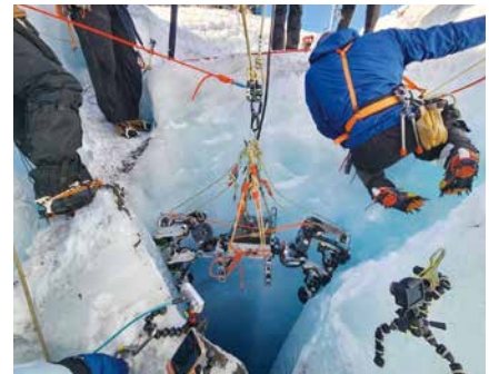
図4：アサバスカ氷河におけるEELSの垂直降下試験の様子
