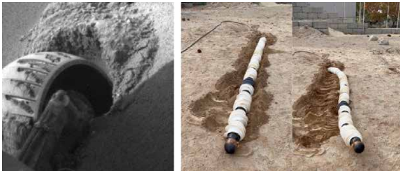
図3：(左) 火星ローバー・オポチュニティは砂地からの脱出に39火星日を要したが、(右) EELSは簡単に脱出できた。
