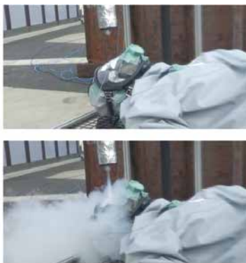
左：液体水素供給実験設備(手前の小屋に評価対象機器があります) 右：防護服を着たマネキンに液体水素を噴射する実験の様子
