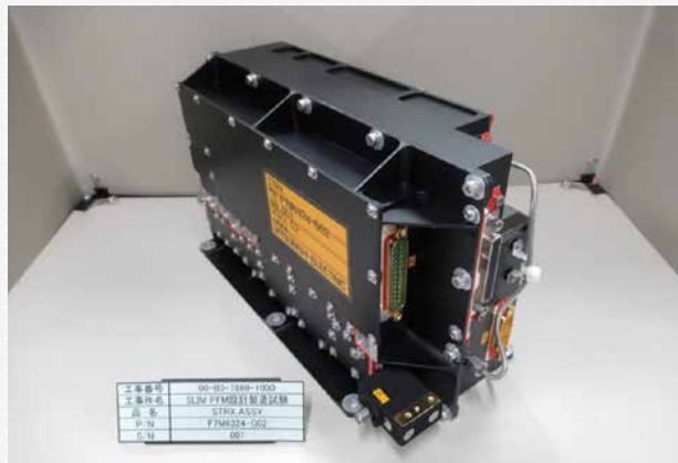
世界初のダイレクトインプット・アウトプット型のSバンドトランスポンダ (STRX)
