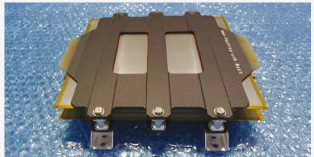
図2：SUSラミネート型二次電池セルが組み込まれた電池モジュール（SLIMには4台搭載）。
