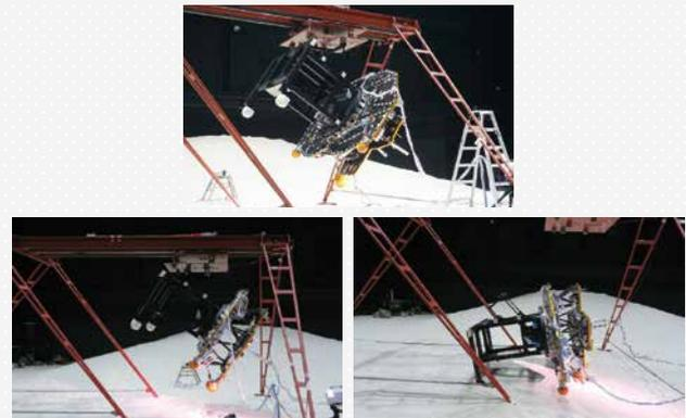
図2：模型落下試験。
