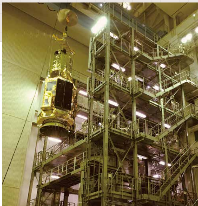
SFAにおける衛星とフェアリングの結合作業。
