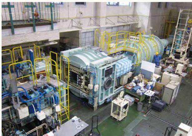
高速気流総合実験設備 (遷音速風洞)。
