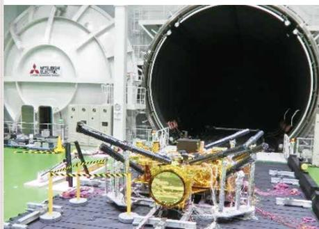
探査モジュールTTM試験 (TTM:Thermal Test Model)
