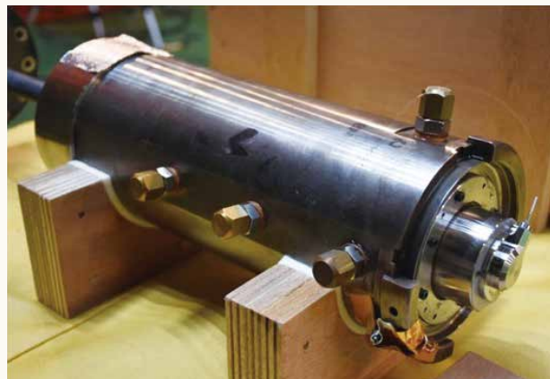
OMOTENASHI超小型固体ロケットモータと真空燃焼試験の様子。
