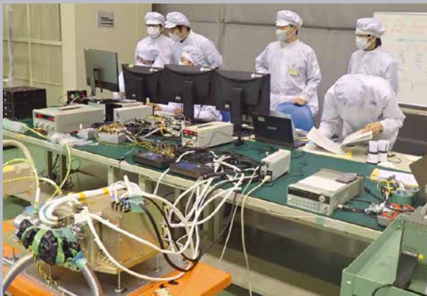
図2：つくばで実施した機能試験の様子。手前がフライト品カメラ。
