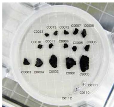
図2: 2回目のタッチダウンで採取した大型の粒子。キュレーション作業で付与されたサンプル名も示す。なお、写真右下の3つの金属片は、サンプル採取時に発生した探査機器限の人工物(アルミ片)である。シャーレの外径は6cmで、刻印されているグリッドの間隔は5mm。
