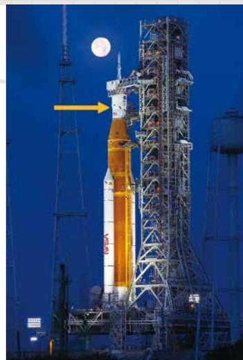
2022年6月14日、ケネディー宇宙センターにて。打上げリハーサルのため発射点に姿を現したSLS Artemis-1。OMOTENASHIとEQUULEUSは矢印の部分のアダプタ内部に搭載されている。
