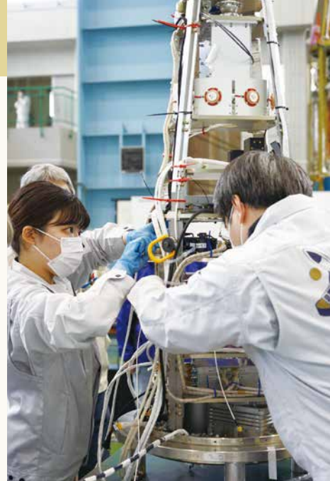
写真2：FM単体をロケットに実装する工程。
