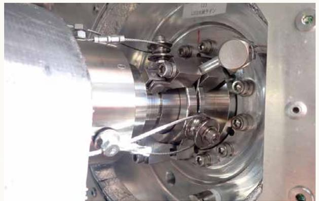
写真：飛翔工学研究系と共同開発したRV-X用QD(飛行試験用液体水素供給離脱継手) @地上燃焼試験(2021年9月)(搭載状態)。
