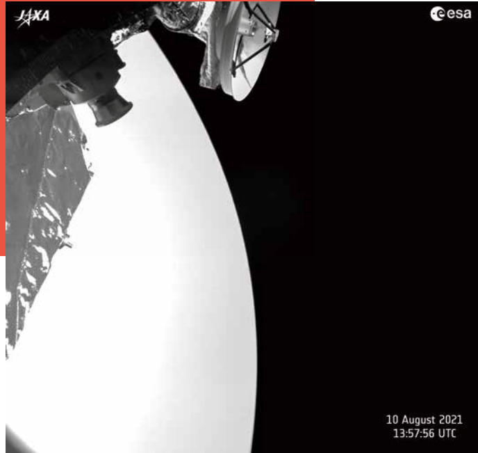
(右) 2回目の「ベピコロombo」金星スイングバイ時、最接近直後に撮影された金星の姿。推進モジュール (Mercury Transfer Module: MTM) に搭載されているモニタリングカメラ (MCAM-3) によって2021年8月10日13時57分56秒 (UT) に撮影された。水星表面探査機 (Mercury Planetary Orbiter: MPO) の本体およびハイゲインアンテナが映り込んでいる。 ©ESA/BepiColombo/MTM
