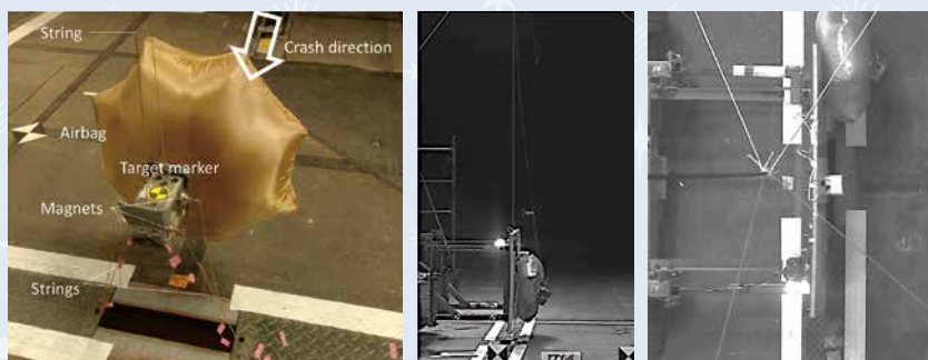
図2：自動車技術研究所での108 km/hの衝突試験の様子(左/試験構成、中/衝突時側面、右/衝突時上面)
