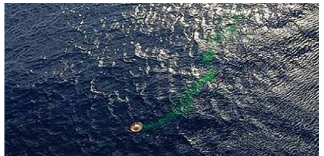
図2：シーマーカーを放出し海上浮遊するRATS(写真提供：朝日航洋)
