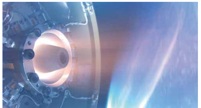
図3：地球を背景に燃焼するRDE(写真提供：名古屋大学)
