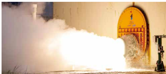
S1R-B3-1TVC真空地上燃焼試験における高性能試験用拡散筒の噴流。
