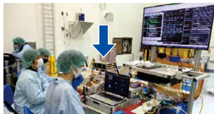
写真2：EQUの動作試験風景（矢印の部分が探査機）。手前のPCで東大と音声をつないで試験を実施した。
