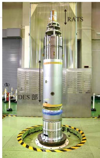
動約合試験待機中のS-520-31頭胴部 (NCを除く)、直径520mmに対する背の高さに注目。
