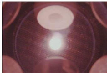
「きぼう」搭載静電浮遊炉の電極間で浮遊する溶融酸化物。
