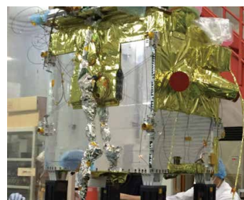
図2 熱真空試験前のフライトモデル。
