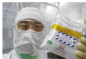
図1 1年間の宇宙曝露を終えてISASに帰還した「たんぽぽ」第4年度捕集パネル。
