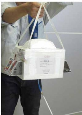
手に持っているのがペイロード部分。太陽電池は両脇にせり出した仰角のついた金属板表面に片面2枚ずつ設置されている。
