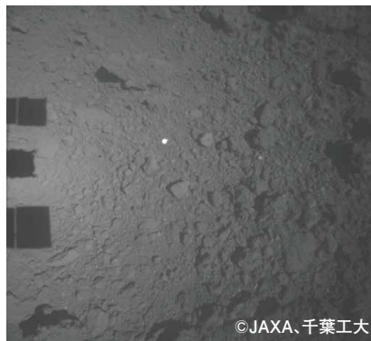
図 広角の光学航法カメラ（ONC-W1）によって撮影された分離直後で降下中のターゲットマーカ（中心付近の白い点）。撮影時刻は2019年5月30日、11:19（機上、日本時間）で、撮影の高度は約10m。左側に探査機の影も見える。
