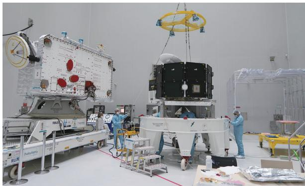
7月2日に行われた「みお」をMOSIFフレームへ結合する様子。MOSIFフレームには「みお」とヨーロッパ側モジュールとの機械的・電気的インターフェースがあります。「みお」には太陽電池パネルを保護するカバーがかけられています。左にあるのがMPO。
