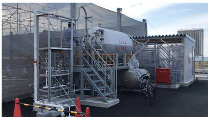
高圧液体水素漏洩拡散・燃焼爆発実験設備。
