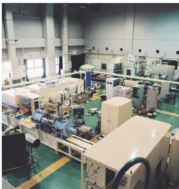
図1 相模原キャンパスD棟3階のプラズマ実験室内に建設された、10mのアーム長を持つレーザー干渉計型重力波検出器プロトタイプTENKO-10。
