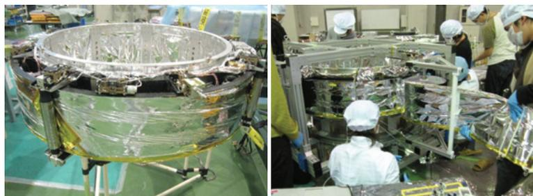
図3 セイル展開機構フライトモデル（左）とセイルを収納している様子（右）
