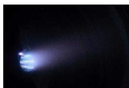
はやぶさ2でも使用されているISAS独自開発のイオンエンジン。少ない推進剤搭載量でも大きな軌道変更が可能となり、高効率推進を実現します。左は運転中のイオンエンジンです。
