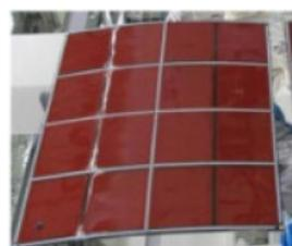
DESTINY+は小型科学衛星の為、大きな電力獲得のために多数、もしくは大面積のパドルを搭載することはできません。その為本機では従来の2倍の出力重量比（100W/kg）を有する軽量かつ高性能な太陽電池パドルの搭載を検討しています。
