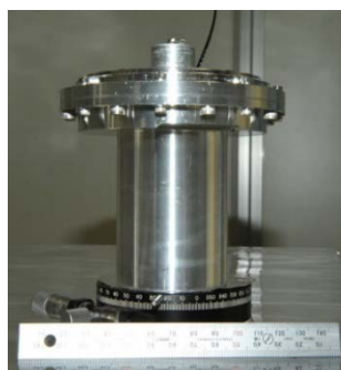
はやぶさサンプルコンテナと内部構造
