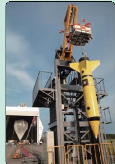
気球から切離して自由落下中に無重力実験を実施する装置(黄色のロケット形状)によって約30秒間の良質な微小重力環境が実現されました
