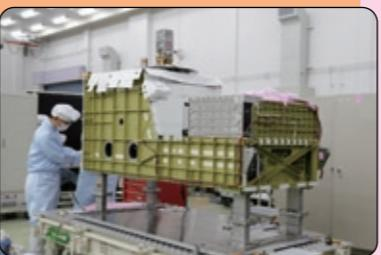
CALET装置は2015年に国際宇宙ステーションに搭載されました。CALETはこれまでの観測では困難であった非常に高いエネルギーの電子やガンマ線、陽子・原子核成分の高精度観測やガンマ線バースト現象の測定を行っています
