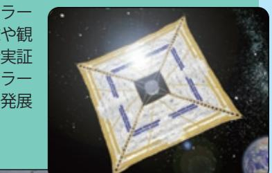
「イカリス」は2010年に惑星間空間へ打ち上げられ、ソーラーセイルの大型膜面展開や太陽光を受けた推進による軌道変更および姿勢制御などの実験を、世界で初めて行いました。大気球や観測ロケットで培われた技術によって惑星間航行のミッションの立案や実行に貢献しています
