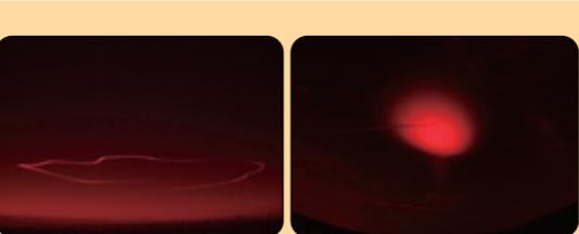
観測ロケットから放出したリチウム蒸気(細い線状や丸い塊状に赤く光る)が風に流されて変化する様子を撮像することにより、中性大気の流れ場の研究が行われています
