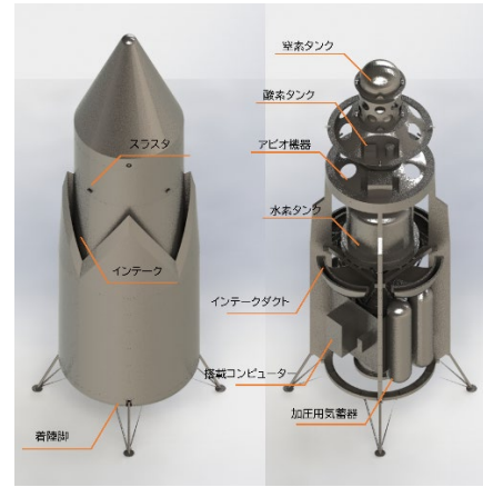
ATRIUM（エアターボ）エンジン燃焼試験の様子と小型 FTB 実験機の概要
