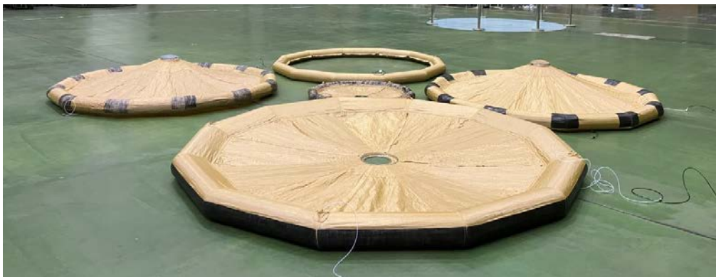
図 4：超小型火星着陸機に向けて試作した直径 3m 展開シェル（中央下），および直径 1.2m（中央），直径 2.5m（その他 3 点，内 1 点はインフレータブルリングのみ）の比較
