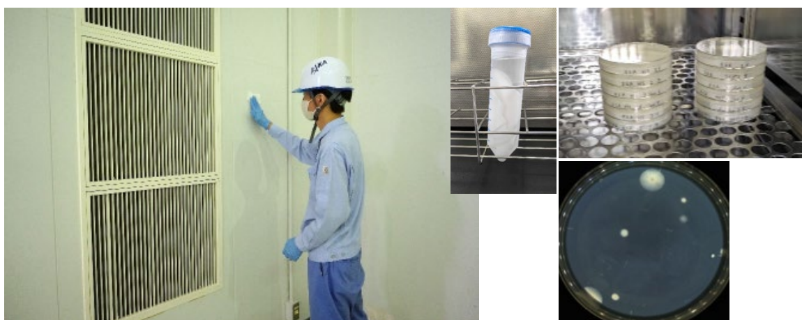
図 4-6. 惑星保護で一般的な微生物数検査法. ここではワイプ(布)の例を示す. 左: 組立室の壁をワイプで拭き取る筆者. 畳み直ししながら 3 方向に丁寧に拭き取る. 中央: 50mL 容量のチューブに入れ、ISAS に輸送されたワイプ. 右上: 試料培養中の寒天プレート. 右下: 培養後の寒天プレートの一例.
