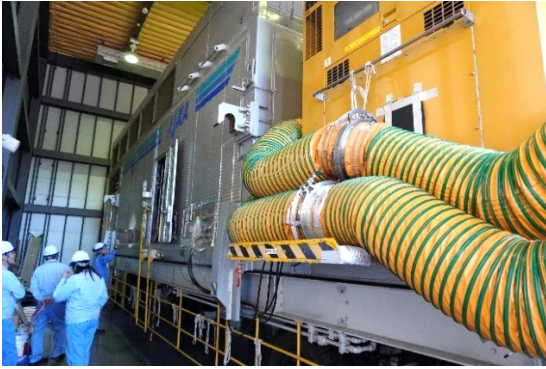
図 4-4. フェアリング空調移動車 (No.2) .SFA 系から VAB への移動時に使用される.かなり大きい. ちなみに運転席はものすごく小さい.
