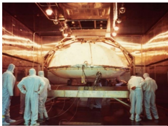
図 1-1 バイキング・ランダーの乾熱滅菌準備中
