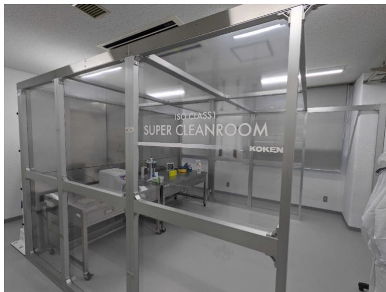
図4 汚染管理を徹底した生物実験用クリーンルーム。
