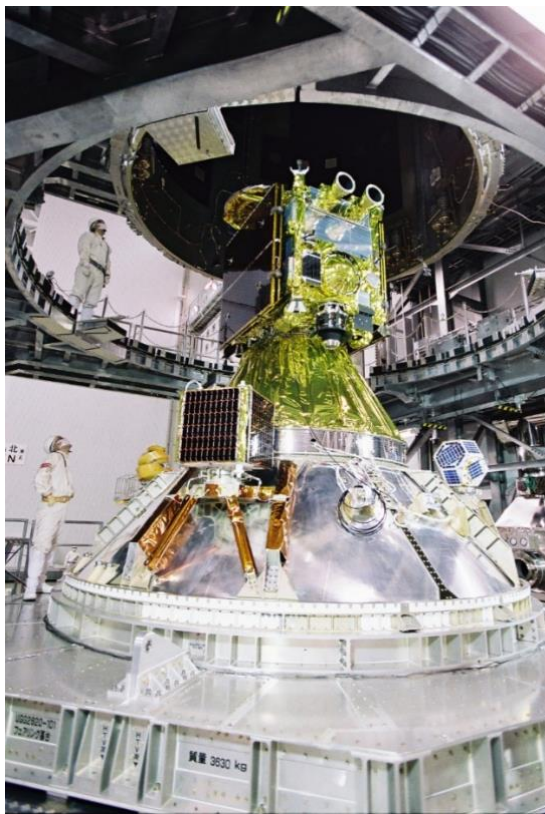
図3 「はやぶさ2」と相乗りで打ち上げた世界初の50kg級超小型深宇宙探査機PROCYON（図の中央左）。
