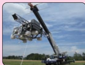
世界初の気球搭載型遠赤外線干渉計望遠鏡
