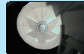
宇宙からの帰還や惑星着陸の際に大面積の膜構造を展開することで機体の空力加熱を避ける新しい柔構造体再突入技術が、大気球と観測ロケットを交互に繰り返し活用しながら開発されています(白色が宇宙空間での展開に成功した柔構造体)
