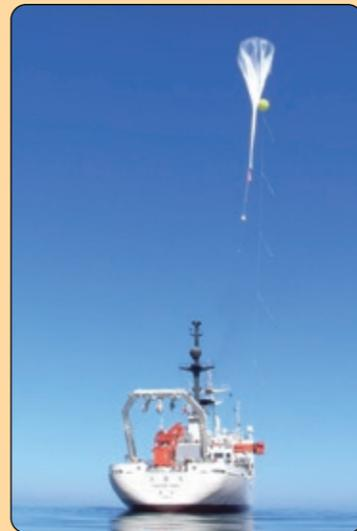
大気球に搭載したクライオサンプリング装置による成層圏大気の採集実験が実施されています。大気球実験の機動性を活かして、国内のみならず、南極・北極・東南アジア・赤道域の太平洋上など世界各地で行われています。これにより、地球規模での大気の循環や大気中の微量成分の分布などが明らかになっており、地球温暖化の研究にも役立っています
