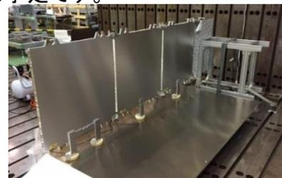
アンテナパネル展開完了状態(片翼)
