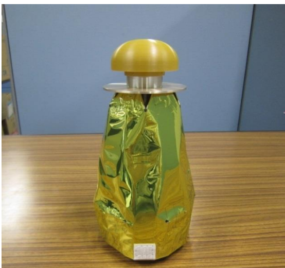
「はやぶさ2」搭載用低利得アンテナ(XLGA) 熱計装(MLI)を付けた状態
