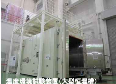
温度環境試験装置(大型恒温槽)
