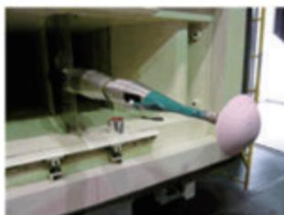
はやぶさカプセル・柔軟構造エアロセルの試験用模型
