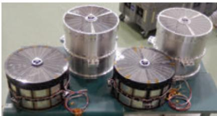
軟X線望遠鏡 (SXT) / 硬X線望遠鏡 (HXT)
