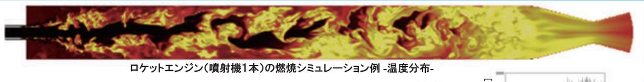
ロケットエンジン(噴射機1本)の燃焼シミュレーション例 -温度分布-
